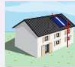
Le petit capteur en toiture est placé dans l'axe des fenêtres existantes.
