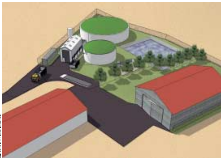
Projet d'unité de méthanisation agricole de biogaz du lycée agricole d'Obernai. Les déchets organiques traités proviendraient pour moitié de l'exploitation agricole (bâtiments d'élevage aux toits rouges) et pour l'autre de l'industrie agro-alimentaire.
